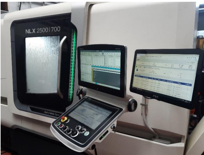
Abb. 2-3: Integrierte Industrie 4.0-Vorrichtungen an Bord der Maschine für die Zeiterfassung mit Opera MES
