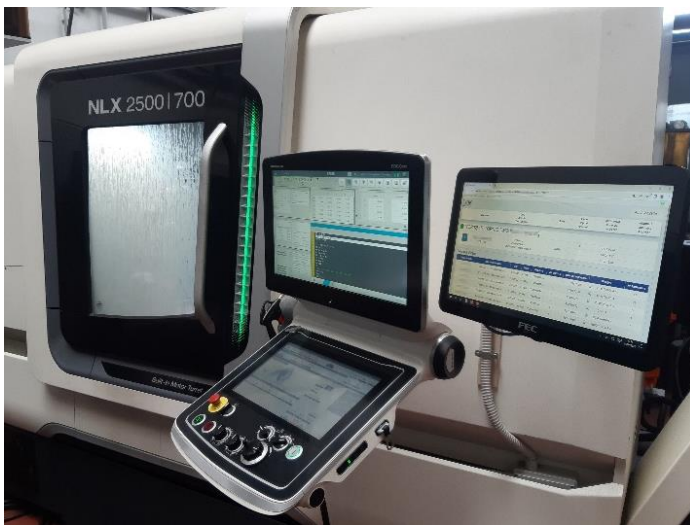
Figure 2-3: Dispositivi integrati di industria 4.0 installati a bordo macchina per rilevazione ore con Opera MES.
